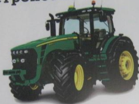
John Deere 825R двигатель PowerTech 9,0 л (285 л.с.)
