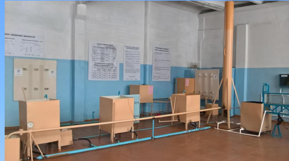
Установка для определения гидравлического удара в напорном трубопроводе
