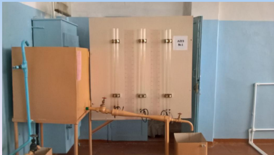
Установка для определения режимов движения жидкости
