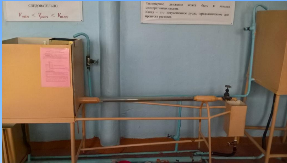
Установка для определения режимов движения жидкости
